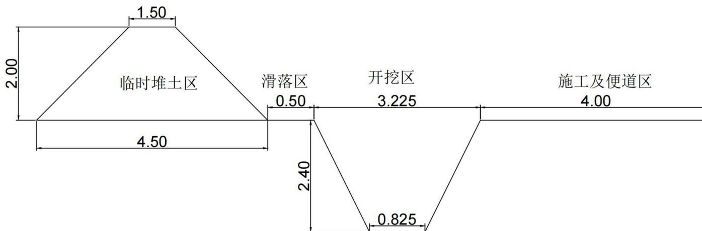
图 2-2 供水管线开挖断面图
