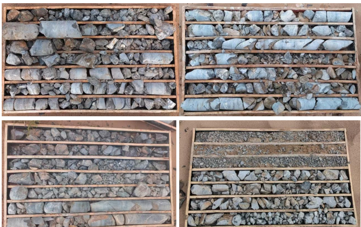
图 2-7 雅干石料矿钻孔揭露上部变质砂岩风化层
